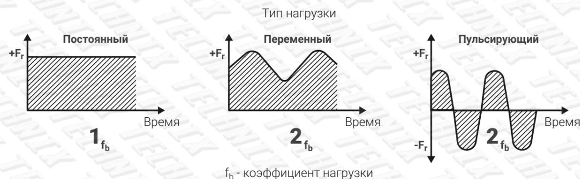
С учетом приведенной выше информации необходимо контролировать условия эксплуатации и при расчете допустимой нагрузки применять следующие понижающие коэффициенты
